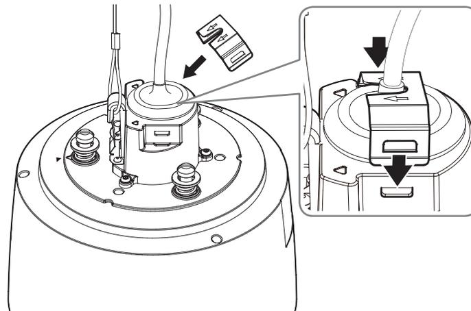
5. Nach der Ausrichtung der Montagerichtungsführungen der Kamera und der Wand- und Stangenbefestigung die Hauptabdeckung nach oben drücken und sie gegen den Uhrzeigersinn drehen bis sie fest ist.
