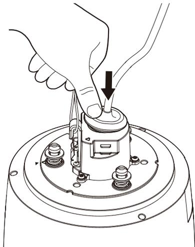
5. Nach der Ausrichtung der Montagerichtungsführungen der Hängebefestigung die Hauptabdeckung nach oben drücken und sie gegen den Uhrzeigersinn drehen bis sie fest ist.
