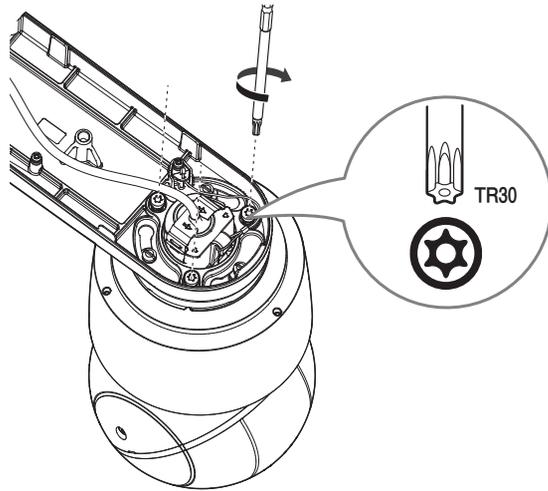
7. Die obere Abdeckung der Wand- und Stangenbefestigung verbinden.
