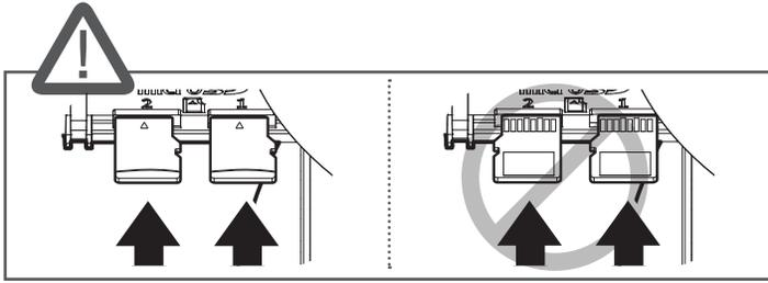
4. Nach dem Einsetzen der Micro SD-Karten den Micro SD-Karten-Einschub hineindrücken bis er einrastet.
