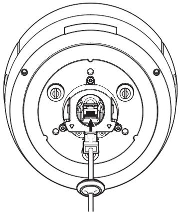
3. Die Kabeldurchführung des Netzkabels in die Bohrung stecken. Beim Einstecken den gesamten Durchführungsbereich gleichmäßig zusammen drücken, so dass sie richtig eingesteckt ist.
