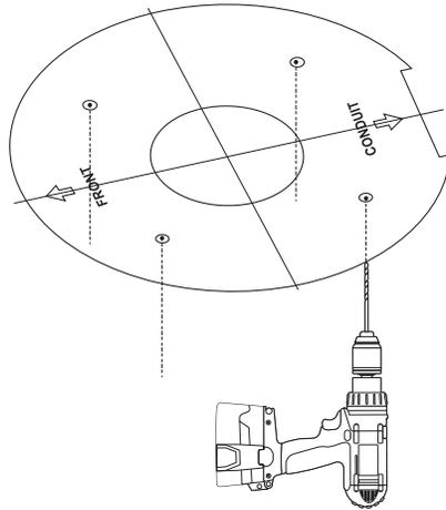
1-2. Die Befestigungsplatte mit den entsprechenden Schrauben befestigen.
