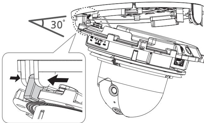
3. Die Kabelabdeckung über das Kameragehäuse ziehen, um es zu öffnen, wie in der Abbildung unten dargestellt.
