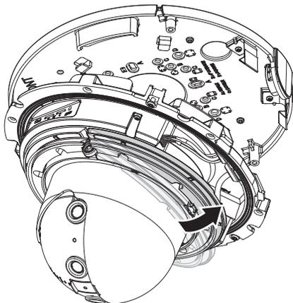
10. Das Kameragehäuse anheben und auf die Befestigungsklammern drücken bis sie einrasten.
