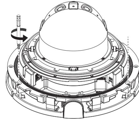
3. An der Befestigungsklammer ziehen, um das Kameragehäuse und die Befestigungsplatte entfernen, wie in der Abbildung dargestellt.
