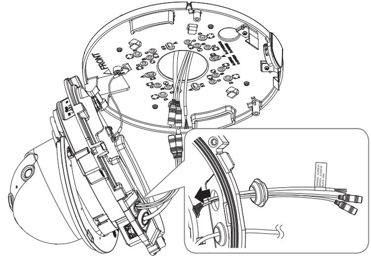
6-4. Den Stecker des Netzkabels mit dem PoE+-Port der Kamera verbinden.
