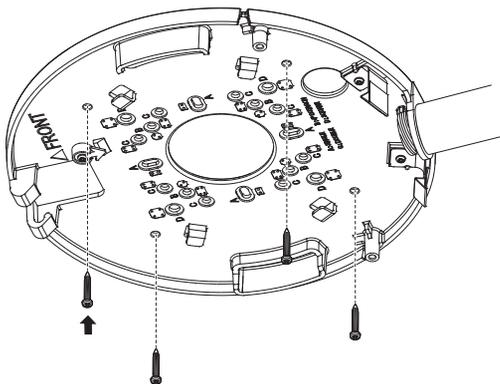
2-5. Erforderliche Kabel unter den Netzwerk-/Stromversorgungs-/Audio-/Alarmkabel durch das Rohr heraus ziehen.
