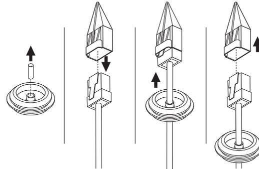
6-3. Die Kabeldurchführung am Kameragehäuse anbringen.
