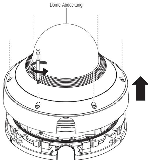
2. Lösen Sie die Befestigungsschraube am Kameragehäuse.
