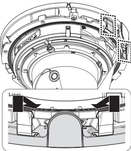
11. Mit den Befestigungsschrauben am Kameragehäuse das Kameragehäuse an der Befestigungsplatte befestigen.
