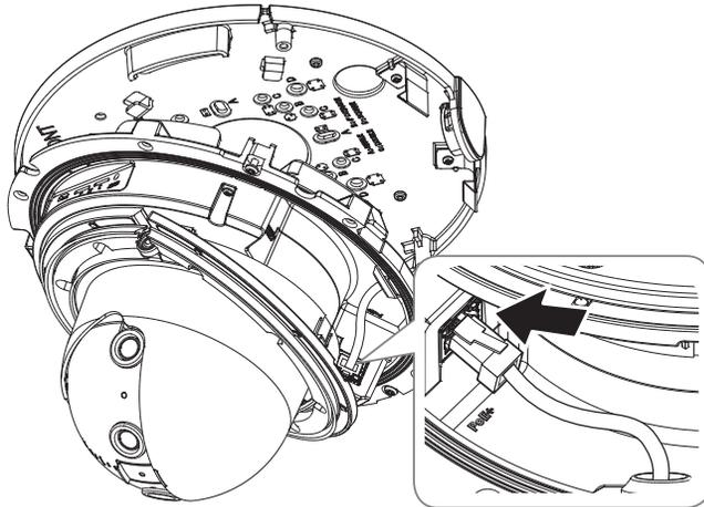
8. Den Steckverbinder des Audio-/Alarmkabels mit seinem Verbindungsanschluss verbinden.
