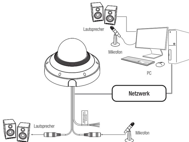
1. Verbinden Sie den MIC Anschluss der Kamera mit dem Mikrofon oder dem LINE OUT Anschluss des Verstärkers, an den das Mikrofon angeschlossen ist.
