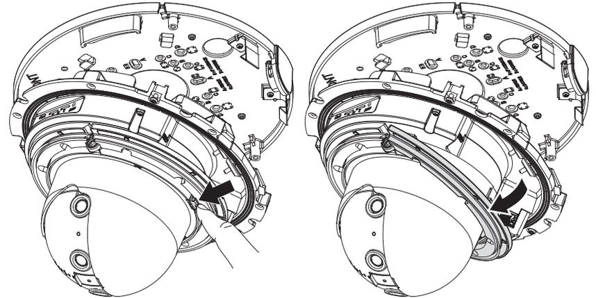
4. Die Kabeldurchführung aus dem Kameragehäuse herausziehen.
