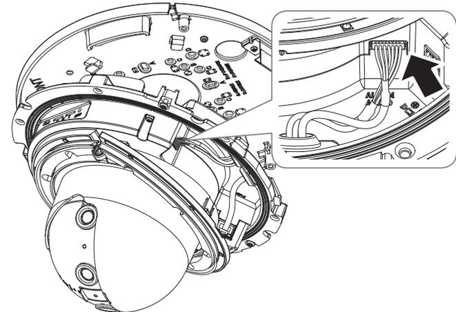
9. Wenn alle Kabelanschlüsse erfolgt sind, die Kabelabdeckung anheben und schließen, so dass sie in der Verriegelung einrastet.
