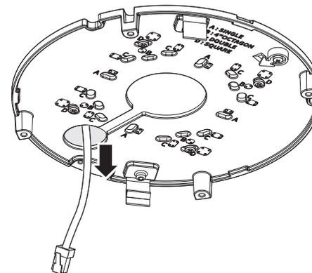
■ Pour raccorder les câbles par le côté, retirez d'abord le couvercle de l'orifice de câblage du couvercle du dôme.
