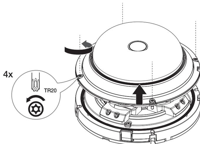
2. Retirez le corps de la caméra et la plaque de montage en tirant sur le clip de montage, comme indiqué sur la figure.
