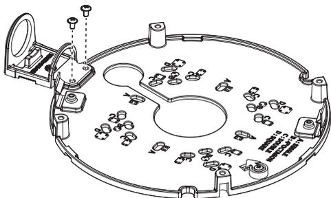
2-3. Montez le tuyau sur l'adaptateur de conduit.
