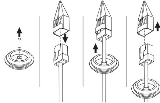
5. Insérez le passe-câble du câble réseau dans le boîtier de la caméra.
