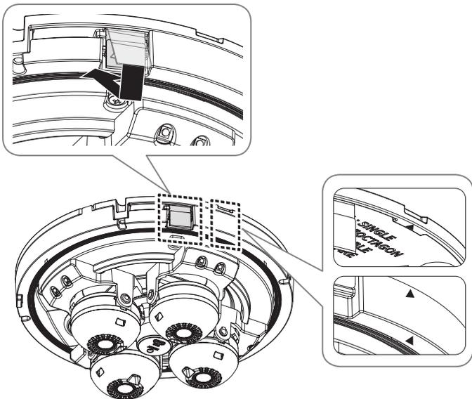
8. Ajustez l'objectif à la direction souhaitée en vous référant à "Réglage de l'orientation de la caméra de surveillance".
